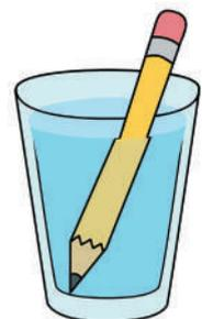
**La refracción.** Es el cambio de dirección que sufren los rayos de luz al variar su velocidad, cuando pasan de un medio a otro que es más denso, o sea que la luz cambia de dirección y de velocidad.
