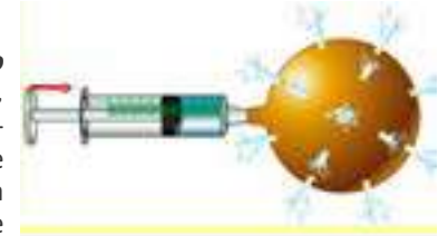
La presión ejercida en un punto de un líquido, se transfiere en todas las direcciones con la misma intensidad
