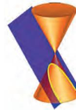
**3.3. Hipérbola:** es una curva plana abierta, compuesta de dos ramas dirigidas inversamente. Surge en la sección producida por un plano que corta a dos conos invertidos paralelamente a sus ejes.
