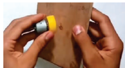
Pegamos el motor con la tapa a la madera
