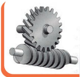
**Tornillo sinfín y corona.** Esta transmisión está formada por un tornillo y una rueda dentada llamada corona. Se emplea para transmitir movimiento circular entre dos ejes perpendiculares que se cruzan. La transmisión no es reversible, es decir, el tornillo siempre es el elemento conductor y la corona el conducido.
