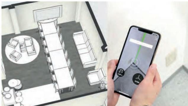
**MagicPlan:** Es una aplicación para iPhone y el iPad que es capaz de medir, dibujar los planos a través de las fotografías realizadas con las cámaras del dispositivo móvil. No es necesario medir manualmente con cinta métrica, la aplicación es capaz de añadir el plano de la vivienda que se requiera.
