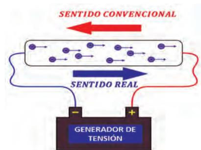
**Sentido convencional:** La Comisión Electrotécnica Internacional (CEI) establece que el sentido de la corriente, esta dada por el sentido del movimiento de cargas positivas, de mayor potencial eléctrico a menor potencial eléctrico y en sentido del campo eléctrico: “Las cargas eléctricas se mueven de positivo a negativo”.
