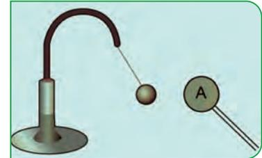
**El electroscopio:** Es un aparato que permite detectar la presencia de una carga eléctrica; se basa en la acción reciproca de las cargas eléctricas.
