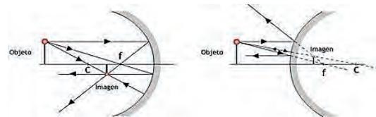
A partir de la figura que se muestra a la derecha se puede deducir una ecuación que nos permite realizar cálculos en espejos esféricos:
