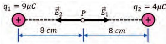
**Solución:** el campo eléctrico de la primera carga va hacia la derecha (será positivo), el campo eléctrico de nuestra segunda carga va hacia la izquierda (será negativo). Entonces decimos que:
