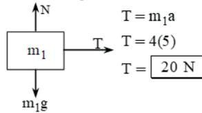
3. En el sistema hallar la fuerza de contacto entre los bloques.  $m_1 = 10 \text{ kg}$ ,  $m_2 = 6 \text{ kg}$ . El coeficiente de fricción con la superficie horizontal es 0,6, ( $g = 10 \text{ m/s}^2$ ).
