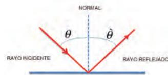
**Reflexión especular:** Esta reflexión se produce cuando las irregularidades del ambiente son pequeñas si las comparamos con las de longitud de onda de la luz.
