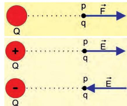
La dirección del campo  $E$ , tiene la dirección de la fuerza  $F$  y su sentido, es el sentido de la fuerza que actúa sobre una carga de prueba positiva. En consecuencia, si una carga puntual positiva se coloca en un punto donde existe un campo eléctrico, queda sujeta a una fuerza que tiene la misma dirección y sentido de dicho campo.
