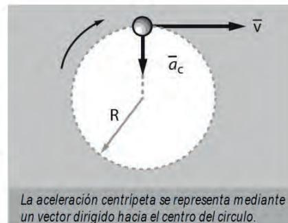
La aceleración centrípeta se representa mediante un vector dirigido hacia el centro del círculo.
