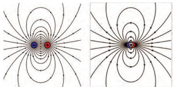
El momento dipolar eléctrico es un vector cuya dirección y sentido siempre es de la carga negativa hacia la positiva, como se muestra en la figura adjunta. Se expresa en Coulomb por metro (C·m):
