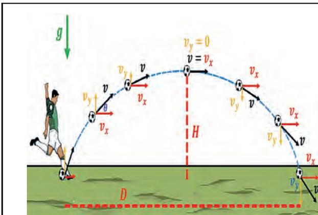
De la imagen podemos observar que: el vector rojo “ $v_x$ ” la componente en el eje horizontal del movimiento la velocidad es constante (MRU), el vector naranja “ $v_y$ ” la componente en el eje vertical la velocidad varía (MRUV) por ello al alcanzar su altura máxima resulta  $v_y = 0$  y empieza a caer cambiando de dirección. Dado que se trata de un movimiento compuesto, es posible definir los dos tipos de movimiento involucrados:
