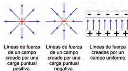
Campo eléctrico uniforme es aquel en el que el vector  $E$ , tiene el mismo módulo, la misma dirección y el mismo sentido en todos los puntos. Un campo eléctrico uniforme se puede obtener cargando dos placas planas paralelas con cargas iguales y contrarias colocadas a una distancia muy pequeña. Entre ellas, el campo  $E$  está dirigido desde la placa positiva hacia la negativa. Del mismo modo, las líneas de campo son paralelas y dirigidas hacia la placa negativa.
