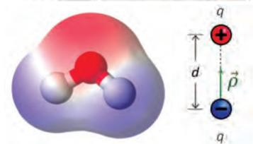
Una molécula de agua es polar debido al reparto desigual de sus electrones en una estructura “doblada”. Hay una separación de carga con carga negativa en el medio (tono rojo) y carga positiva en los extremos (tono azul).
