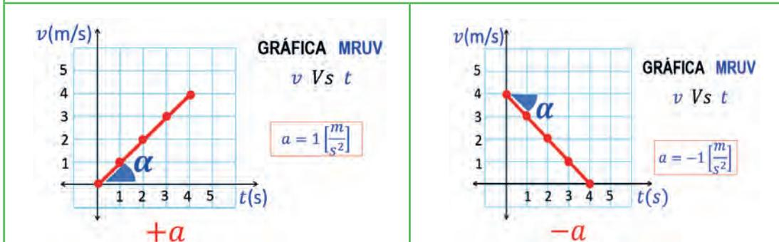
A partir del ángulo  $\alpha$  puedes obtener la aceleración. Recuerda para ello que, en un triángulo rectángulo se define la tangente de uno de sus ángulos como el cateto opuesto partido la hipotenusa. El valor de la pendiente es la propia aceleración. Por tanto, a mayor pendiente de la recta, mayor aceleración posee el cuerpo.
