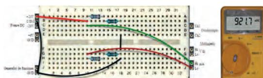
Figura 3: Medida de corriente en la nueva rama
