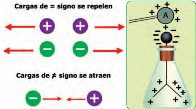
Si a un electroscopio cargado positivamente se le acerca (sin tocarlo) otro cuerpo cargado positivamente, las láminas se separan más (acción de cargas del mismo signo o nombre), y si se acerca un cuerpo cargado negativamente, estas se juntan.
