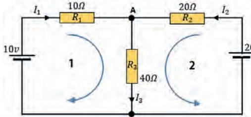
Determinemos los valores de la corriente  $I_1$   $I_2$   $I_3$   $I_4$   $I_5$  del siguiente circuito.
