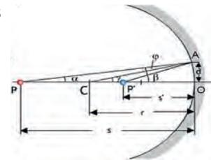
Para los triángulos rectángulos con vértices en P, C y P' se cumple:  $\text{tg } \alpha = \frac{d}{s}$ ;  $\text{tg } \beta = \frac{d}{s'}$ ;  $\text{tg } \gamma = \frac{d}{r}$
