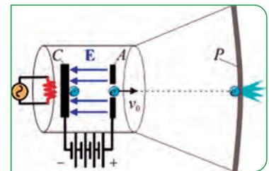
Las gotas de tinta de una impresora componen las letras gracias a la aplicación de un campo eléctrico que le manda la posición exacta en el papel. Ten en cuenta que el espacio es muy pequeño y no se puede hacer con métodos mecánicos.
