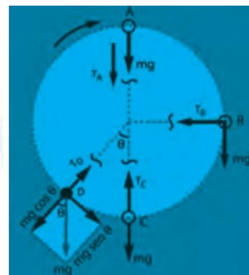
2. Se hace girar una piedra en un plano vertical. Cuando pasa por el punto "A" tiene una velocidad de 10 m/s, en "B" tiene una velocidad de 15 m/s y en "C" 20 m/s. Calcular la tensión en A, B y C sabiendo que  $m = 4 \text{ kg}$   $R = 2 \text{ m}$  ( $g = 10 \text{ m/s}^2$ ).
