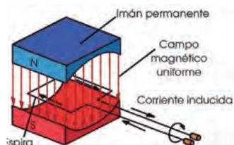
Faraday hizo pasar un imán por el interior de una bobina de un circuito eléctrico y observó que, al meter y sacar el imán en la bobina, se generaba una corriente eléctrica en el circuito (corriente inducida) que cambiaba de sentido según que se introdujese el imán en la bobina o se sacase de ella, y cuya intensidad aumentaba al aumentar la velocidad del movimiento del imán. Este fenómeno recibe el nombre de inducción electromagnética.
