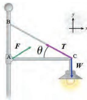
El foco se sujeta mediante una barra y un cable, ambos fijos en la pared mediante soportes. Las diversas fuerzas que actúan deben asegurar que el cartel no se caiga.
