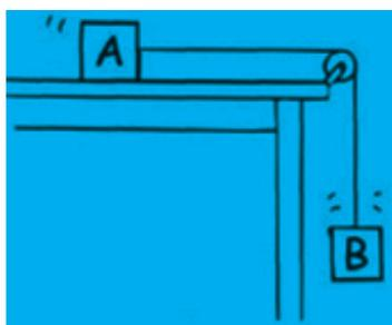
1. Sobre una mesa en posición horizontal se coloca un bloque de madera (A) de 3 kg de masa, unido mediante una cuerda inextensible que pasa por una polea a otro bloque (B) de 0.8 kg que cuelga. Sabiendo que el coeficiente de rozamiento dinámico entre la madera y la mesa es de 0.2, calcular:
