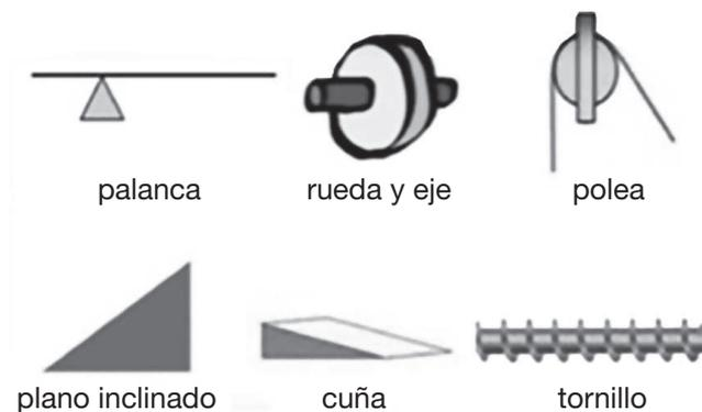
**La rueda, la palanca, la polea simple, el tornillo, el plano inclinado, el polipasto, el torno y la cuña son algunas máquinas simples.**
