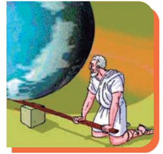
Al realizar un movimiento lineal de bajada en un extremo de la palanca, el otro extremo experimenta un movimiento lineal de subida. Por tanto, la palanca nos sirve para transmitir fuerza o movimiento lineal.
