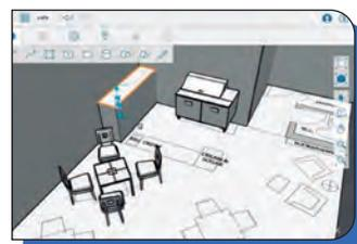
BIM (Building Information Modeling), es una característica avanzada en el diseño arquitectónico ya que cuando se modifica un muro o se ubica una puerta la aplicación cambia automáticamente las dimensiones de las áreas y genera los presupuestos entre otras características avanzadas. (Onstruyehogar, 2022)
