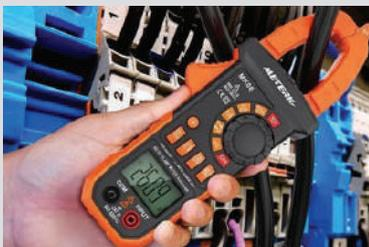
El cable eléctrico al ser rodeado por la pinza amperimétrica genera un campo magnético dentro del aparato de medida indicándonos que cantidad de amperios circulan por un cable conductor y que son consumidos por un determinado aparato eléctrico.
