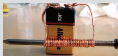
**Efecto magnético:** Cuando una corriente eléctrica pasa a través de un conductor, crea un campo magnético alrededor del conductor. Este principio se utiliza en electroimanes y en la operación de motores eléctricos.
