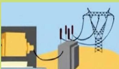
En el generador, la energía mecánica producida por la turbina se convierte en energía eléctrica.
