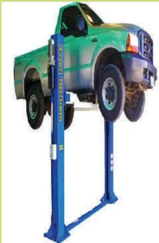
El funcionamiento de un elevador hidráulico se basa en la teoría física del principio de Pascal. En palabras simples, consiste en la transmisión uniforme de energía a partir de la presión que se ejerce para poder levantar los autos dependiendo del nivel de altura y del peso del vehículo.
