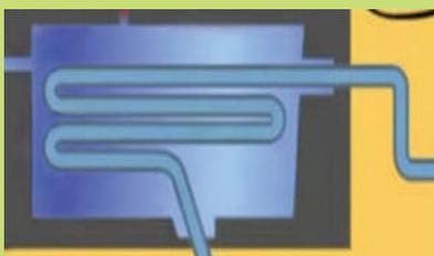
El vapor que sale de la turbina vuelve a transformarse en agua líquida para iniciar de nuevo el proceso de producción de vapor.
