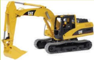
Los pistones de las maquinarias pesadas, consiste en un fluido (agua o aceite) en un receptáculo con dos pistones móviles de distinto tamaño en sus extremos. Cuando se ejerce fuerza sobre el pistón pequeño, se traduce en una fuerza superior en el pistón grande. Cumpliéndose el principio de Pascal.
