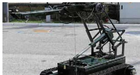
Los robots de brazo largo constan de un brazo articulado y extensible en cuyo extremo puede disponerse una pinza, una herramienta de corte o cualquier otro dispositivo. También disponen de sensores para adaptarse a la pieza sobre la que trabajan.
