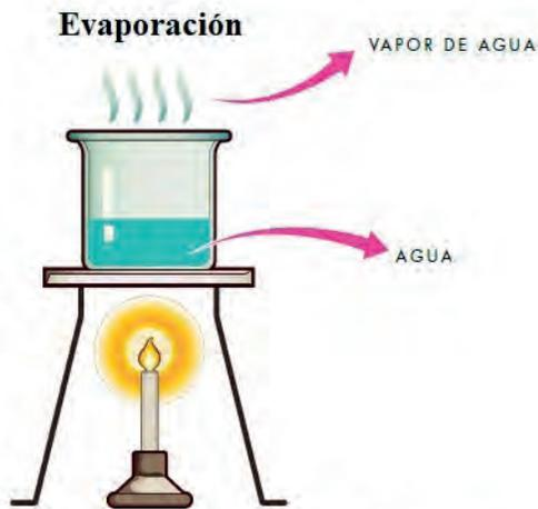
Métodos de separación de mezclas Evaporación
