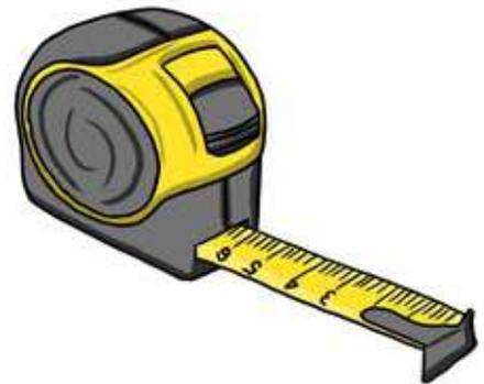
248. **Flexómetro:** *m*. Cinta métrica metálica enrollada a presión dentro de una caja
