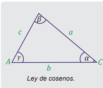
b) **Ley de coseno.** Es la relación que existe entre los lados de un triángulo y los ángulos del mismo, siempre y cuando no sea un triángulo rectángulo. Esta ley establece que el cuadrado de cualquiera de los lados de un triángulo no rectángulo es igual a la sumatoria de los cuadrados de las longitudes de los otros dos lados, menos el producto de esas longitudes por el coseno del ángulo que los une. Matemáticamente se puede expresar:
