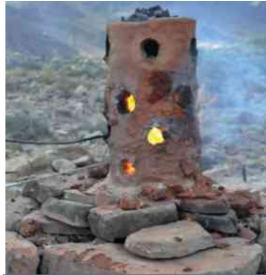
Huayra, horno para fundir minerales de la época prehispánica.
