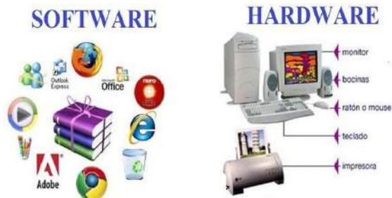
Por otro lado, el *hardware* comprende los elementos tangibles o físicos, eléctricos, electrónicos y electromecánicos. Nos referimos al monitor, el teclado, el *mouse*, el CPU, los cables, los circuitos, el chasis, los periféricos y otros.
