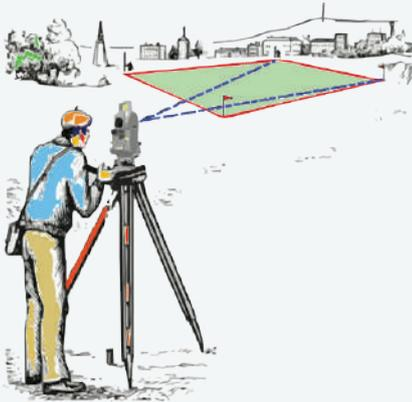
Un topógrafo se encarga de medir y cartografiar el terreno, esto incluye la toma de medidas de elevación, distancia y ángulos y también utilizan sistemas de GPS para cartografiar el terreno. Los topógrafos suelen trabajar en empresas de construcción, ingeniería o topografía.
