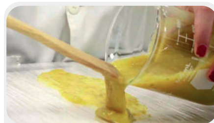
Preparación del bioplástico de cáscara de mango.
