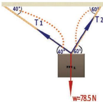
Ahora descomponemos las tensiones  $T_1$  y  $T_2$  en el eje de las abscisas y ordenadas tomando en cuenta los respectivos ángulos.
