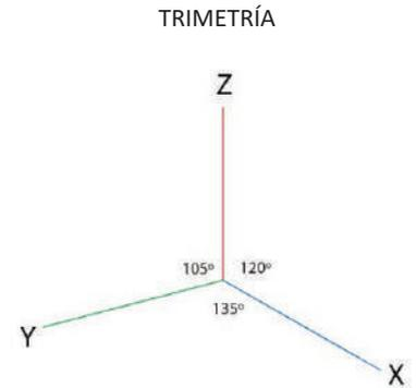
Imagen 7: TIPOS DE PERSPECTIVA AXONOMÉTRICA
