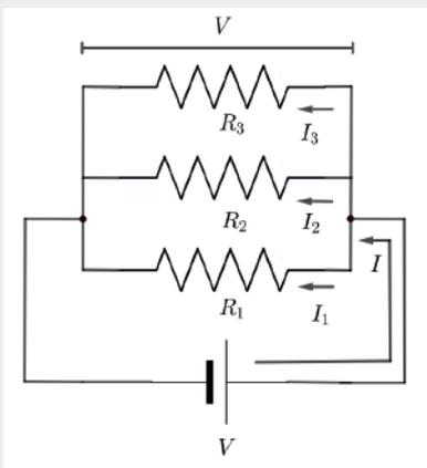
Despejando la corriente de la ley de Ohm y reemplazando:
