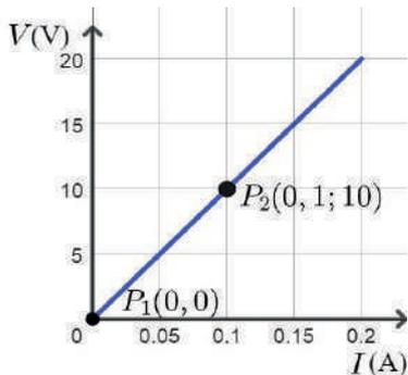
La resistencia es igual a:  $R = 100 \Omega$ . Este valor puede ser obtenido por cualquier par de puntos de la recta, se sugiere al lector trabajar con otro par de puntos.
