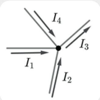
**Ejemplo 2:** A partir del gráfico del recuadro, encontrar el valor de la corriente \$I\_4\$. Si \$I\_1 = 5,0 \text{ A}\$; \$I\_2 = 4,0 \text{ A}\$; \$I\_3 = 2,0 \text{ A}\$.
